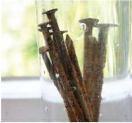
चित्र 6.5 लोहे की कौलों/पेचों की जंग लगना।
