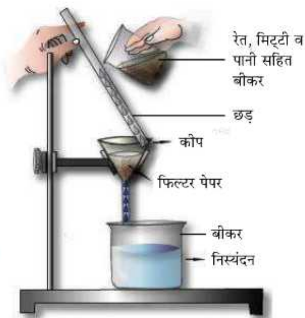
चित्र 5.13 फिल्टर पेपर की सहायता से फिल्टर करना
