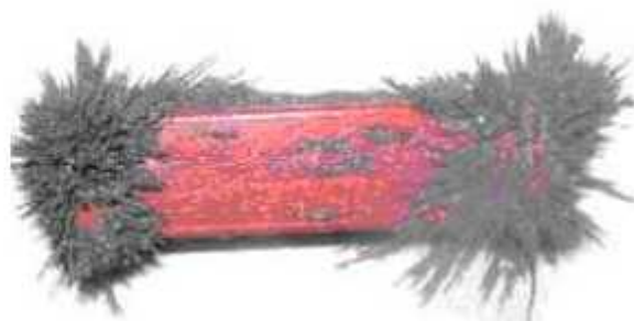
चित्र 13.9 छड़ चुंबक के साथ चिपकी हुई लोहे की बारीक कतरनें
